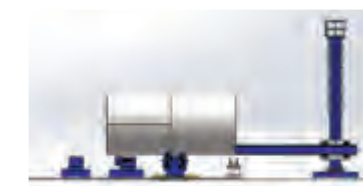
D、第一段内环缝焊接 D、 Inner circular seam welding
