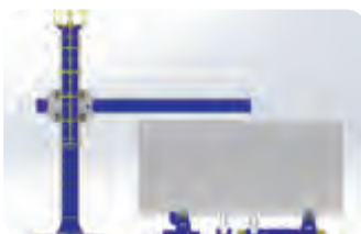
E、外环缝焊接 E、Outer circular seam welding
