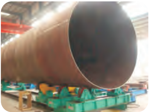
液压组对滚轮架 Hydro fit up rotator
