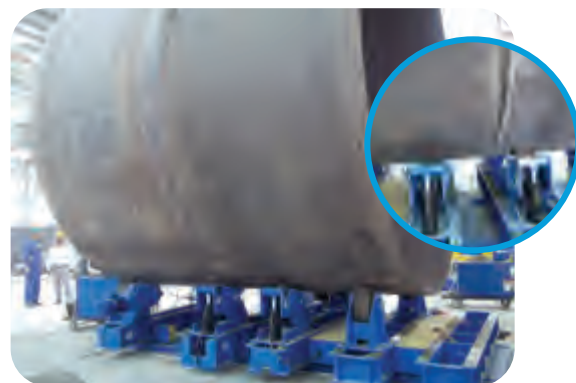
B、第二个单节上料 B、Load No.2 pipe
