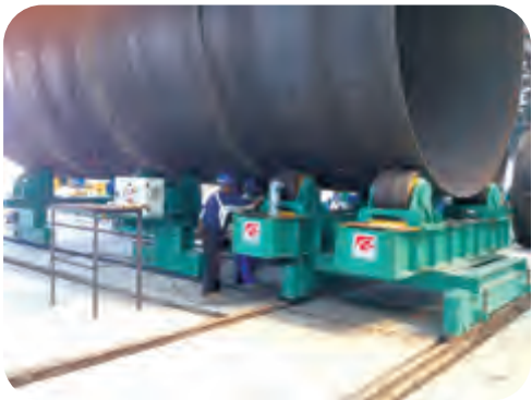
液压组对滚轮架 Hydro fit up rotator
