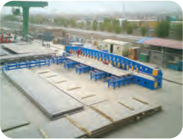
双头高速铣边机 开制坡口 Double head high speed edge milling machine
